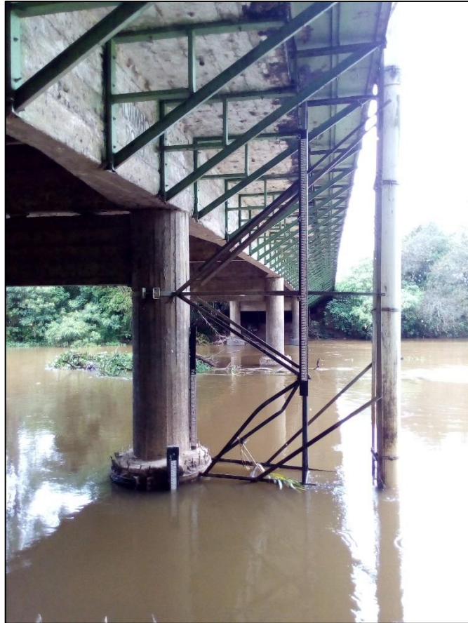
Figura 1 Régua de Aferição no Rio das mortes Fonte: própria autora
